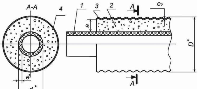
**Рис. 1.3 – Конструкция ГПИ-трубы ИЗОКОМ А 115/1,0**
