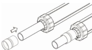
4. Надеть гильзу надвижную на напорную ГПИ-трубу внутренней фаской к торцу напорной ГПИ-трубы
