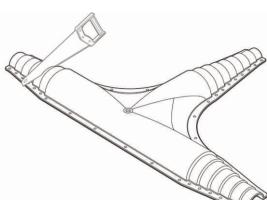
1.    Обрезать концы верхней и нижней половин полимерного кожуха по уровню метки, соответствующей наружному диаметру защитной оболочки ГПИ-трубы.
