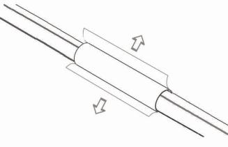
6. Прогреть пламенем газовой горелки полиэтиленовую оболочку с двух сторон стыка. Обернуть вокруг прогретой оболочки и зафиксировать ленту kleевую с двух сторон стыка. Надвинуть муфту на место стыка. Усадить муфту пламенем газовой горелки.
