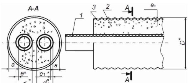
**Рис. 1.5 – Конструкция ГПИ-трубы двухтрубного исполнения ИЗОКОМ 95/0,6**
