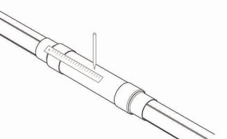
9. Перьевым сверлом (D=20 мм) просверлить отверстие для заливки пенополиуретана
