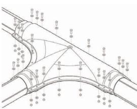
6. Соединить верхнюю и нижнюю половины полимерного кожуха при помощи крепежных элементов.
