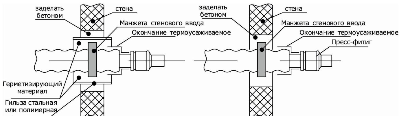
**Рисунок 8 – Герметизирующий узел ввода в здание**
