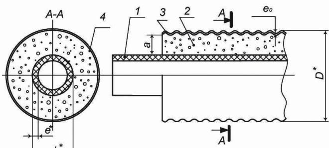
**Рис. 1.2 – Конструкция ГПИ-трубы ИЗОКОМ А 95/1,0**
