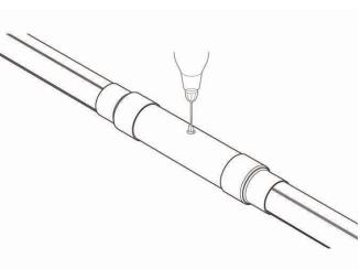
10. Приготовить смесь компонентов ППУ путем перемешивания их при помощи электродрели со специальной насадкой в полимерном ведре. Залить полученную смесь через подготовленное отверстие. Вставить в заливочное отверстие пробку дренажную.
