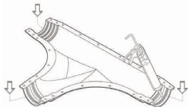
2. Нанести герметик на обе половины полимерного кожуха в местах последующего прилегания поверхности защитных оболочек ГПИ-труб. Герметик должен быть нанесен по всему периметру прилегания ГПИ-трубы непрерывной полосой толщиной не менее 5 мм.
