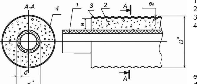
**Рис. 1.4 – Конструкция ГПИ-трубы ИЗОКОМ 95/0,6**
