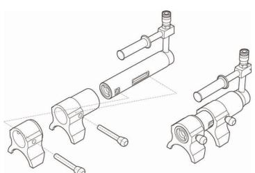
6 Подготовить гидравлический инструмент к работе: установить на гидроцилиндре опорную и подвижную губки, закрепить их фиксаторами.
