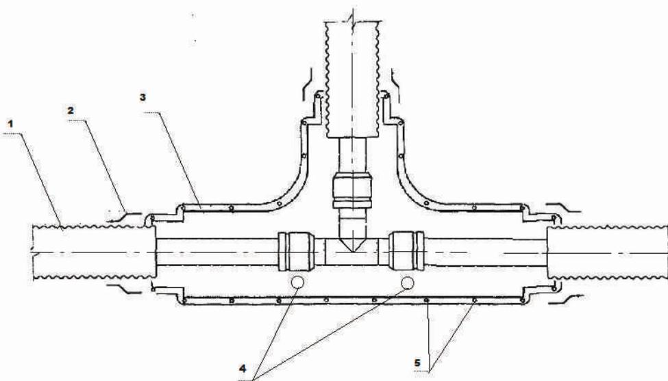
**Рисунок 7- Конструкция стыкового соединения с защитным полимерным кожухом.**
