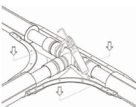
4. Нанести герметик на нижнюю половину полимерного кожуха по линии последующего соединения с верхней половиной.
