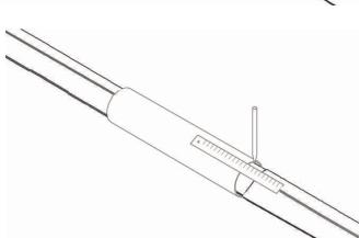
4. Используйте рулетку или линейку, отцентрировать положение муфты, относительно оси стыка; нанести маркером соответствующие риски
