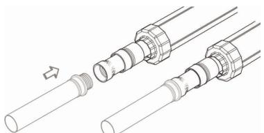
5 Вставить втулку пресс-фитинга с приваренным металлическим патрубком внутрь напорной ГПИ-трубы до упора.
