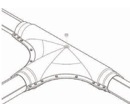
8. После завершения процесса пенообразования закрутить герметизирующую пробку (рис. 4.6.8).
