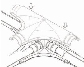
5. Установить верхнюю половину полимерного кожуха; совместить отверстия для болтов на верхней и нижней половинах кожуха.
