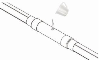
12. После завершения процесса пенообразования удалить пробку дренажную. Установить пробку монтажную, заварить ее при помощи специального инструмента. В зависимости от температуры окружающей среды время пенообразования может меняться.
