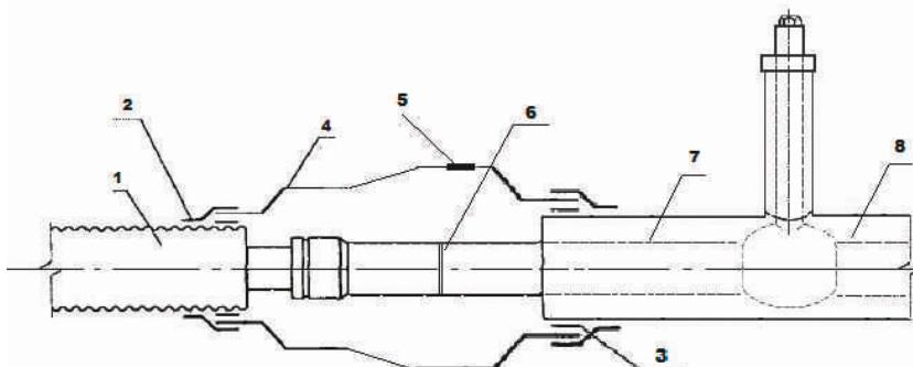
**Рисунок 6 - Конструкция переходного стыкового соединения с ГПИ-трубами на стальное Пи-изделие с переходной термоусаживаемой муфтой.**
