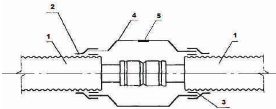
**Рисунок 3 - Конструкция стыкового соединения с термоусаживаемой муфтой.**
