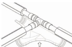
3. Расположить нижнюю половину полимерного кожуха под изолируемым тройником таким образом, чтобы она плотно прилегала к поверхности ГПИ-труб в местах нанесения герметика
