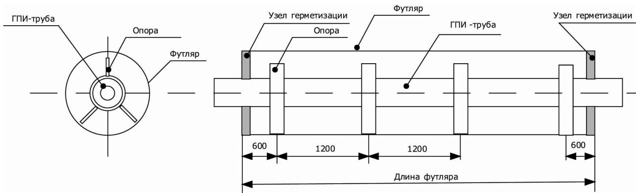
*Рисунок 4 – Узел прокладки в футляре*
