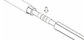
3. Обезжирить растворителем (или другим спиртосодержащим раствором) полиэтиленовую оболочку ГПИ-труб с обеих сторон от стыка на расстоянии 150-200 мм
