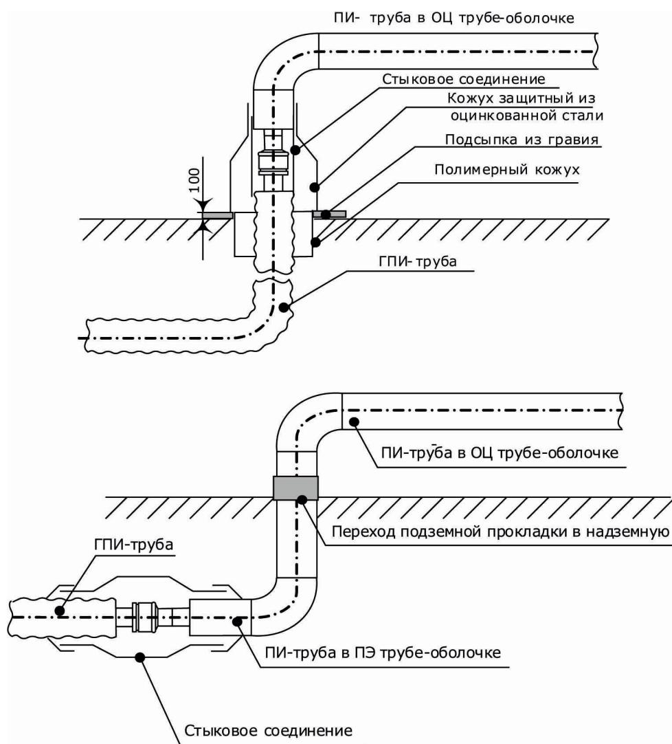
*Рисунок 5 – Узлы перехода подземной прокладки в надземную*
