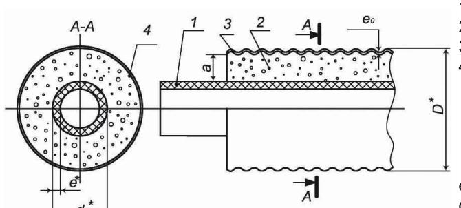
**Рис. 1.1 – Конструкция ГПИ-трубы ИЗОКОМ 95/1,0**
