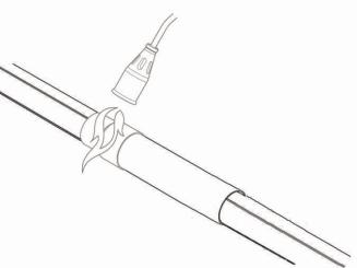
7. Зачистить наждачной бумагой область наклейки термоусаживаемой ленты на полиэтиленовой оболочке и термоусаживаемой муфте. Обезжирить места наклейки. Обернуть термоусаживаемой лентой край муфты и полиэтиленовой оболочки с равномерным нахлестом, подогревая ленту пламенем горелки. Провести термоусадку ленты.
