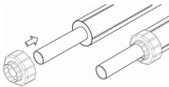
3. Надеть окончание термоусаживаемое на подготовленный к монтажу конец ГПИ-трубы
