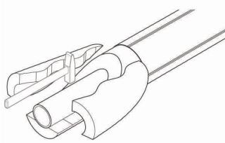
5. Сбить молотком освобождённый от полиэтиленовой оболочки слой теплоизоляции
