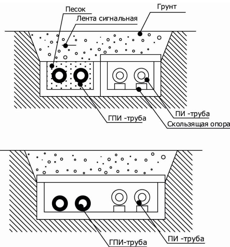
*Рисунок 3 – Узлы прокладки в непроходных каналах*
