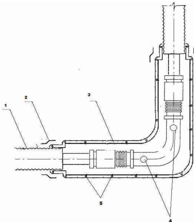
**Рисунок 8- Конструкция стыкового соединения с защитным полимерным кожухом.**
