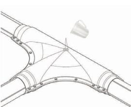
7. Выкрутить пробку для заливки пены в верхней половине кожуха.
