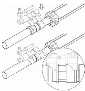
7 Установить гидравлический инструмент таким образом, чтобы подвижная опорная губка тисков вошла в сцепление с буртами на гильзе надвижной и втулке пресс-фитинга
