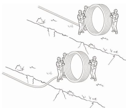
Следует избегать перетаскивания ГПИ-труб через дороги, по каменистой почве и другим грубым абразивным поверхностям. Для предотвращения возможных повреждений защитной оболочки ГПИ-трубы следует использовать подставки или другие защитные приспособления.
