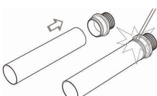
1. Перед проведением монтажных работ ко втулке пресс-фитинга предварительно должен быть приварен отрезок стальной ГПИ-трубы длиной не менее 400 мм
